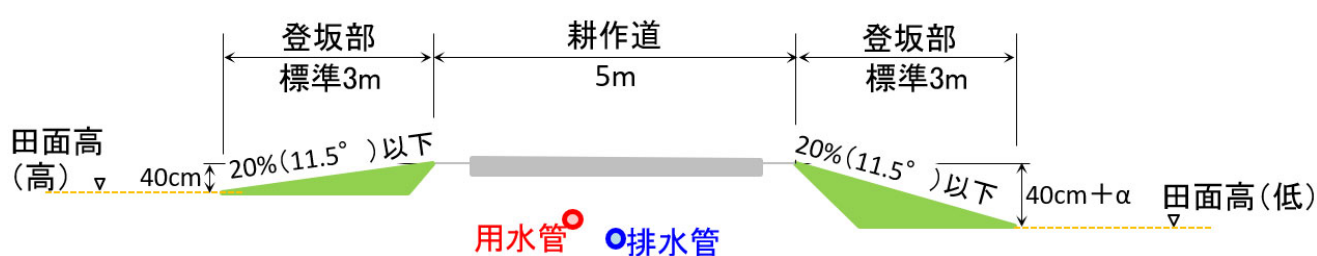
標準断面図(国営妹背牛地区)
