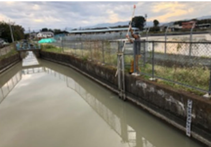
バッテリーで稼働する水田水位計を水路に設置した活用事例（上段：ベジタリア株式会社、下段：株式会社 Amaterz）
