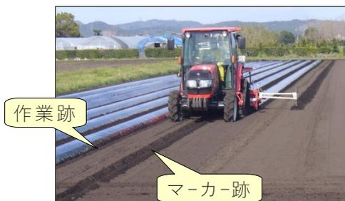
図3 追従走行機能による畝立て作業の例
