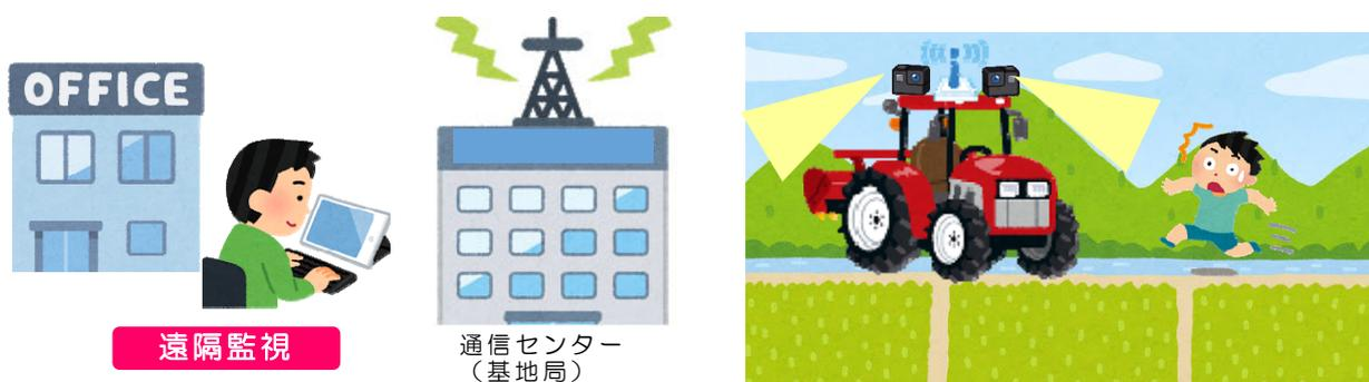
遠隔監視による自動走行を実施する場合には、自動走行農機に設置した周辺監視用カメラにより位置・方向、動作情報をリアルタイム(低遅延、大容量データ通信(動画ストリーミング、連続画像データ等の取得))で取得し、緊急時に一時停止指示・及び安全が確保された際の作業再開の指示等を行うことが求められる。
