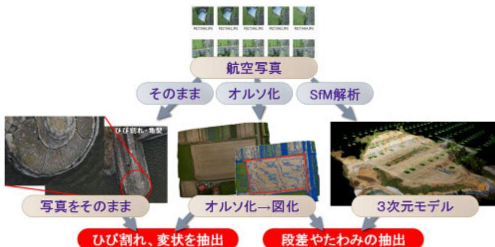
※オルソ化：上空から撮影した空中写真は土地の高低差により歪んだ形状で撮影され、位置のずれが生じる。オルソ（正射投影）により、水平位置の歪みを取り除き、正しい大きさと位置が表示される画像に変換する。
