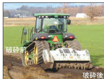
ストーンクラッシャーによる石礫破碎 7)
