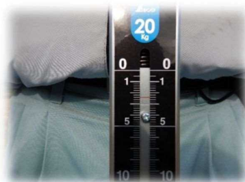
30mm 礫重量計測(例 2.4kg)
