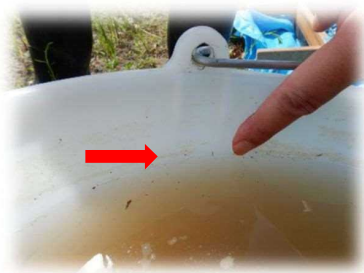
礫の投入後の水位 14 ㍓目盛り
