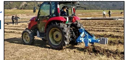
施工状況(農林水産研究指導センター協力) ※カットブレイカーmini(適用トラクター:20~50PS)
