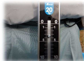
40mm 礫重量計測(例 1.8kg)
