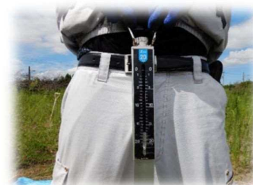
水+礫の重量計測(例 19.4kg)
