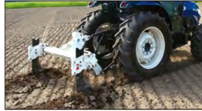
サブソイラによる心土破碎 18)
