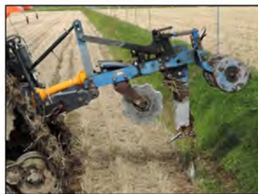
振動式サブソイラと弾丸の組み合わせ
