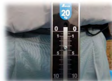
40mm 礫重量計測(例 1.8kg)
