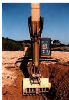
ローターバケットによる混層耕 3)
