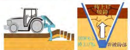
施工の原理(農研機構資料より)
