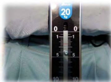
30mm 礫重量計測(例 2.4kg)
