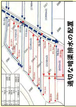
暗渠排水の施工状況
