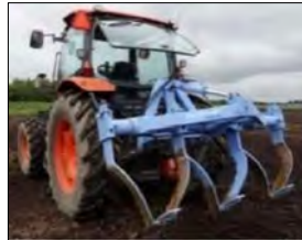
カットブレーカーによる心土破碎 13)
