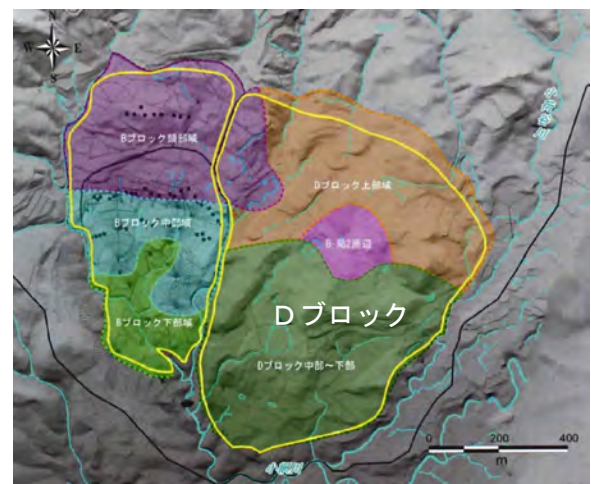
図-4.9.6 地質分布状況に応じたすべり面の透水係数の区分例
