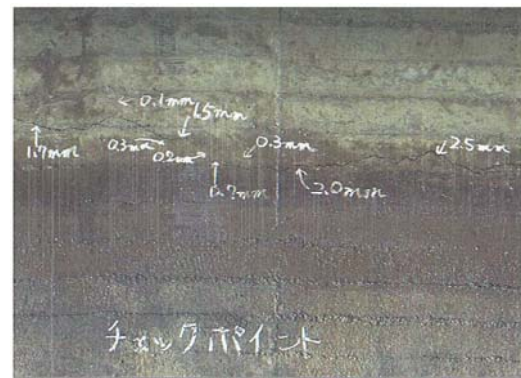
写真-13.5 CCDラインカメラ法による連続画像の拡大図
