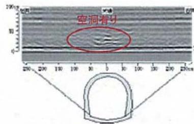
水路トンネル横断レーダ計測結果例
