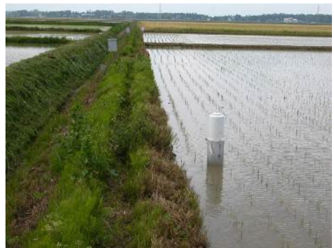
写真-6.5 自記水位計設置例
