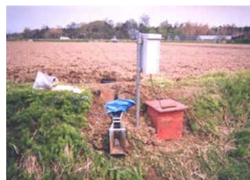
写真-6.3 落水口側設置例
