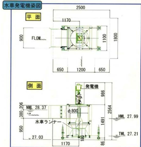
図-22.3 水車発電機の平面図と側面図
