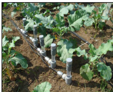
写真-5.1 テンシオメータ設置状況
