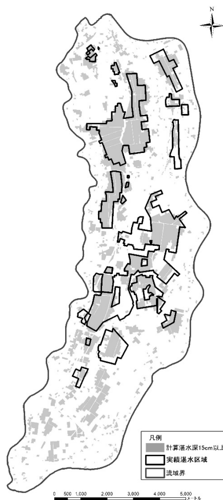
図-17.10 平成 23 年 7 月出水湛水区域比較
