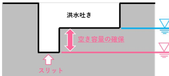
図-16.9 洪水吐きスリットイメージ図
