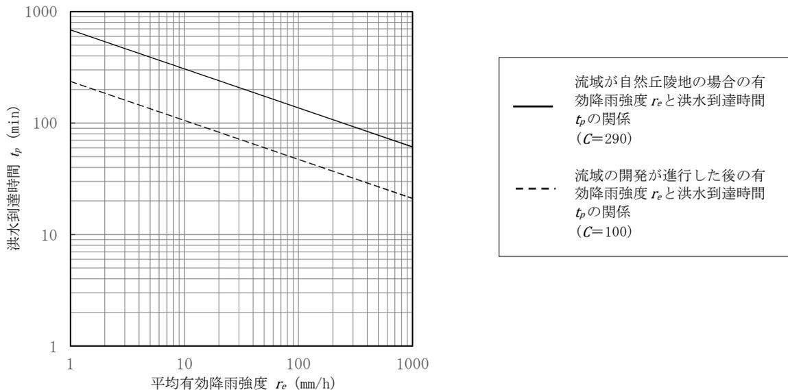
図-3.3 洪水到達時間の変化
