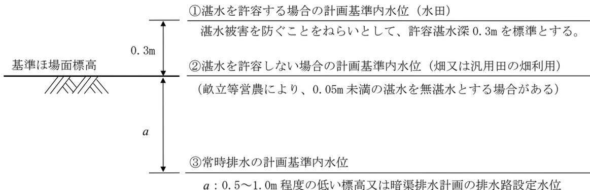
図-13.2 計画基準内水位の概念図
