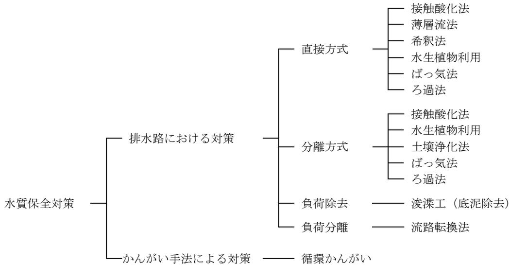
※直接方式：排水路内に水質改善施設を設置し、直接的に水に作用させる方式
