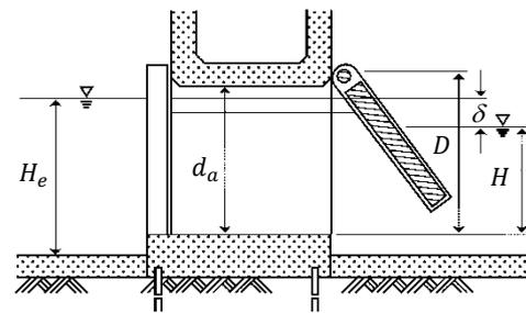
図-12.5 フラップゲート付排水水門の水理諸元
