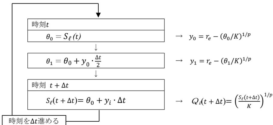
上記の手法による計算例を表-9.5に示す。表において、有効雨量  $r_e$  は降雨量  $r$  について保留量曲線から求めている(「9.2.2 有効降雨量」の項参照)。初期貯留量  $\theta_0$  は、降雨開始から4時間後の時刻をゼロとしている。⑥欄は、遅れ時間  $T_\ell$  を0.6時間として、これを考慮した流出高の計算時刻である。これより、1時間ごとの流出量は、比例配分で内挿して求める。また、図-9.7は、計算結果のハイドログラフを示す。
