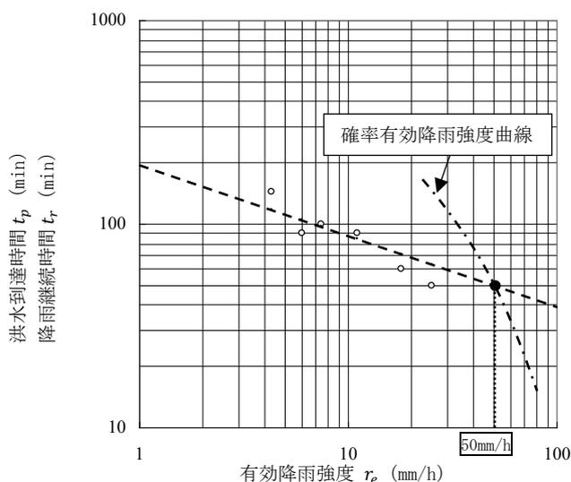
図-8.4 確率有効降雨強度の推定グラフ
