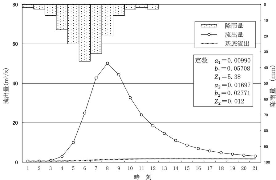
図-9.11 洪水ハイドログラフの計算例
