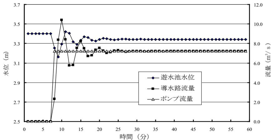
図-4.9 不定流モデル解析結果
