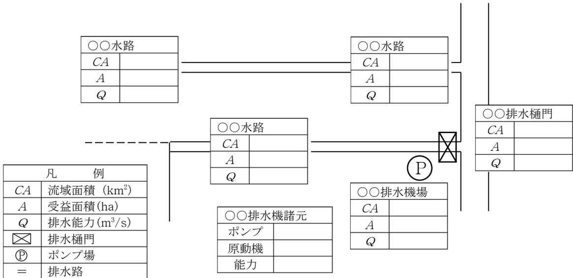
図-3.11 計画排水系統模式図の例
