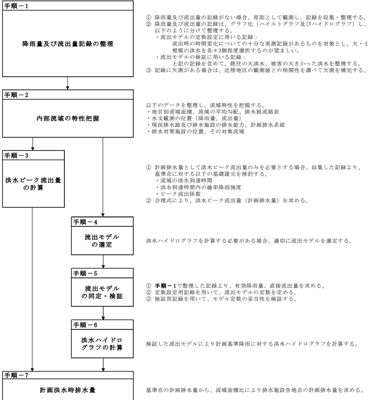
図-3.3.7.1 計画洪水時排水量の計算手順
