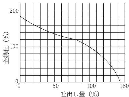
図-13.7 斜流ポンプ特性図 ( $N_s=900$ )
