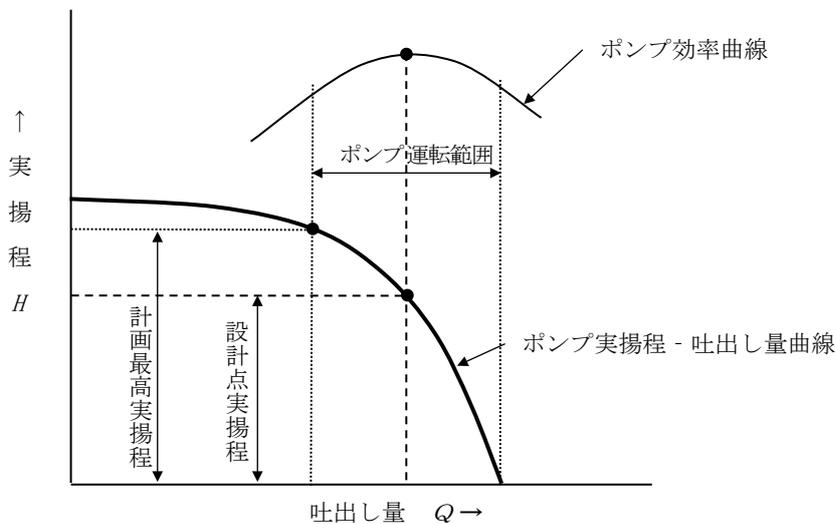
設計点実揚程の仮定  $\approx 0.8 \times$  内外水位差 + 導水諸損失 + スクリーン損失 + 吐出し樋管・樋門等損失
