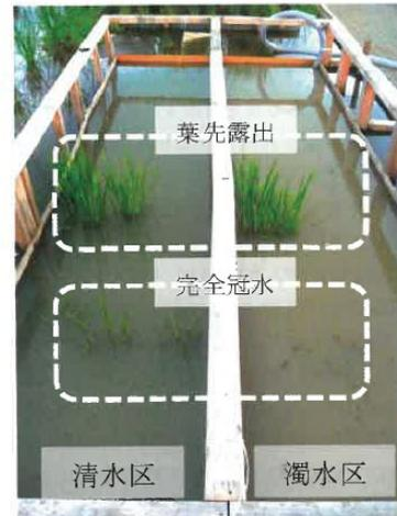
図-5.5 冠水試験中の様子
