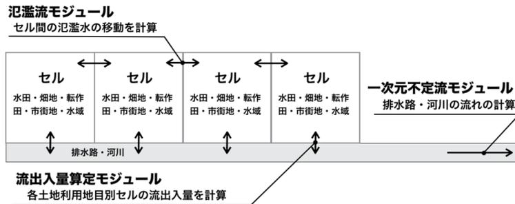
図-17.7 内水氾濫解析モデルの概要
