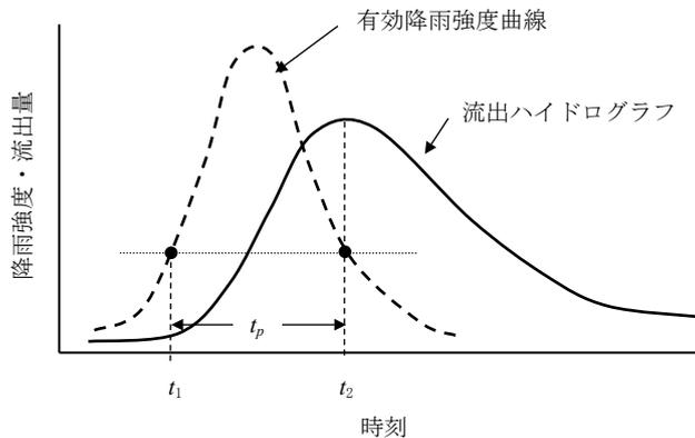
図-8.1 洪水到達時間の定義
