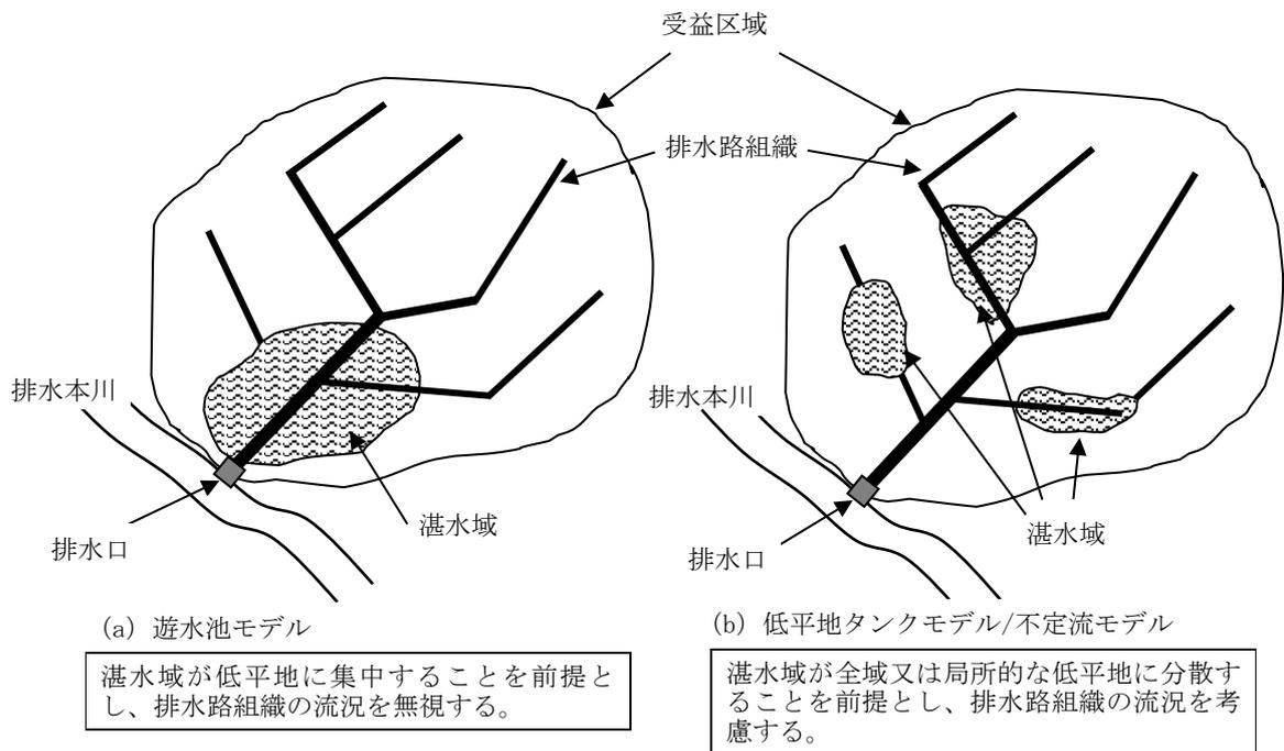
図-4.12 排水解析モデルの概念図
