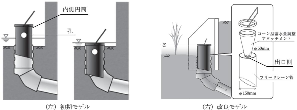
図-16.7 水位調整管（フリードレーン方式）
