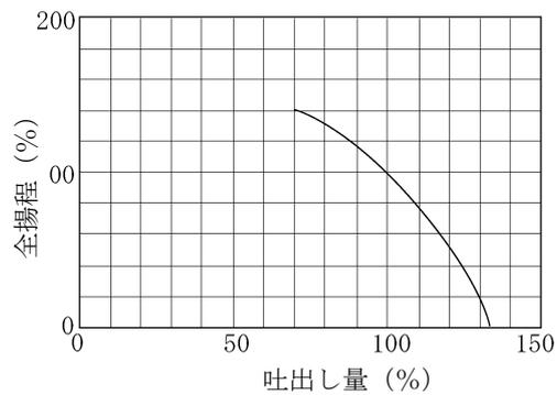
図-13.6 軸流ポンプ特性図 ( $N_s=1500$ )
