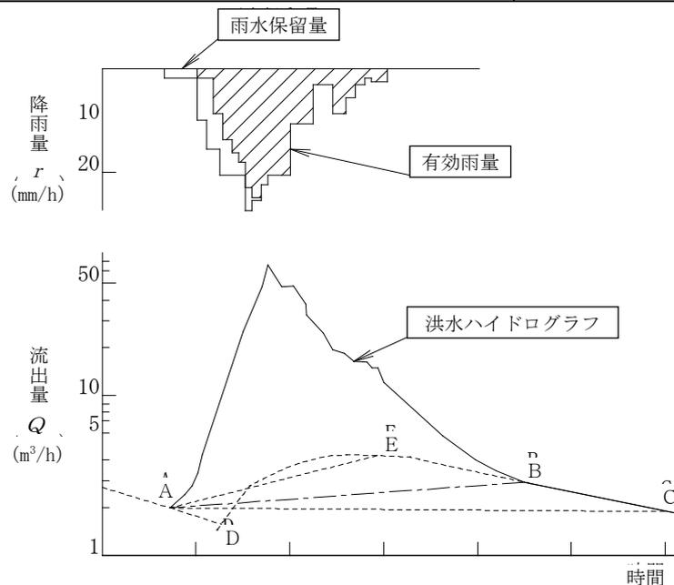
図-9.1 直接流出の分離法
