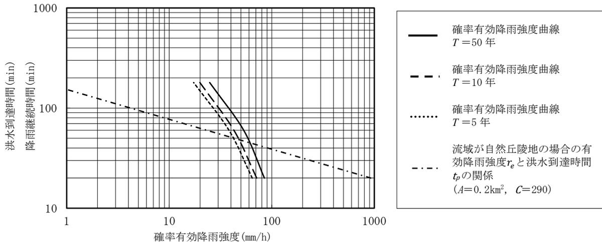
図-6.4 確率有効降雨強度曲線
