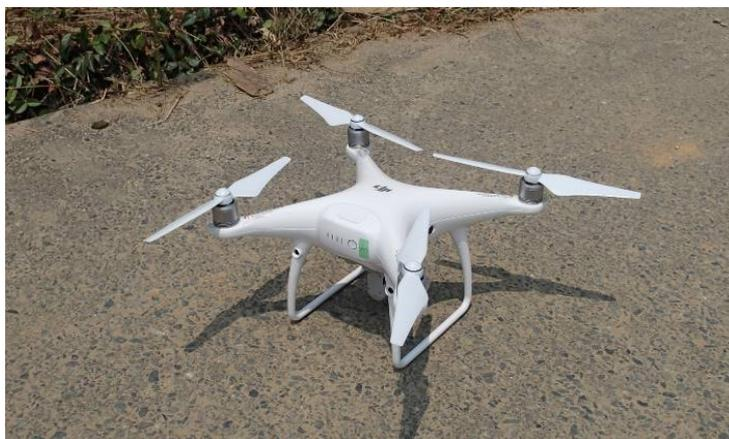
図 4-1 UAV（マルチロータ型）の機体の例
