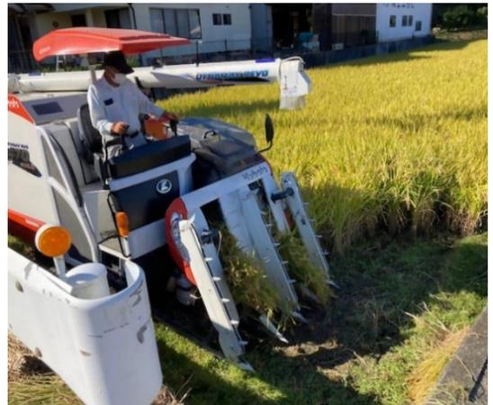
写真 5 収量コンバインによる刈取り
