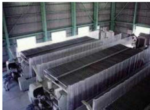
フィルタープレスによる機械脱水
