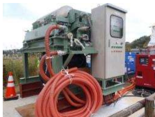
スクリュウデカンタ型 遠心分離機（側面）
