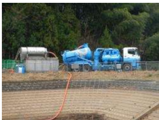
実証事業で使用した強力吸引車（バキュームカー）
