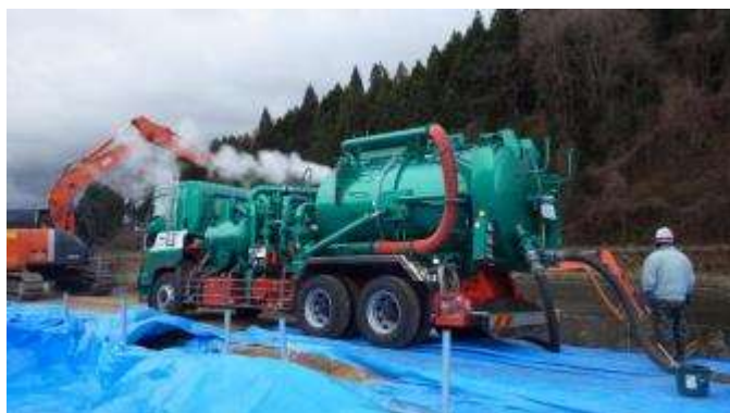
実証事業で使用した強力吸引車（バキュームカー）
