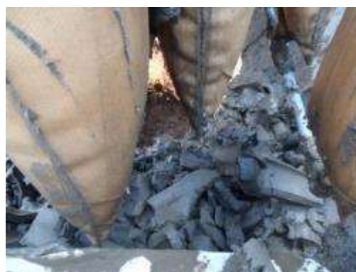
剥離直後の脱水ケーキ
