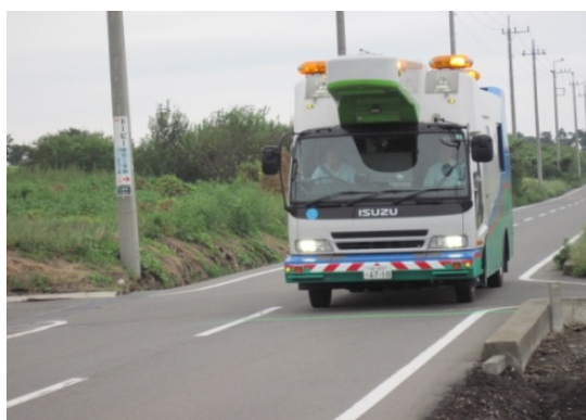
路面性状測定車両による調査
