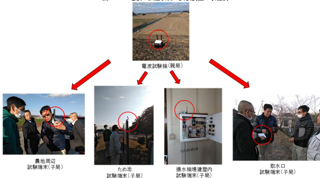
図 3-12 電波の伝播状況の試験調査の取組例
