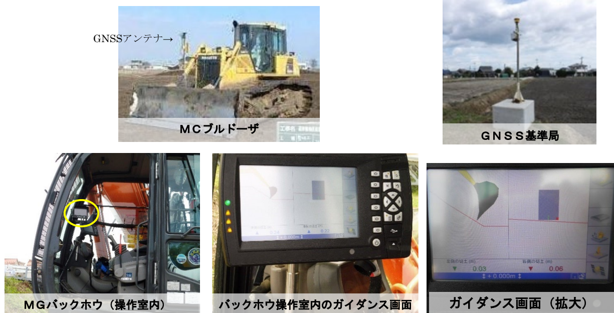
図3 ICT建設機械の構成イメージ
