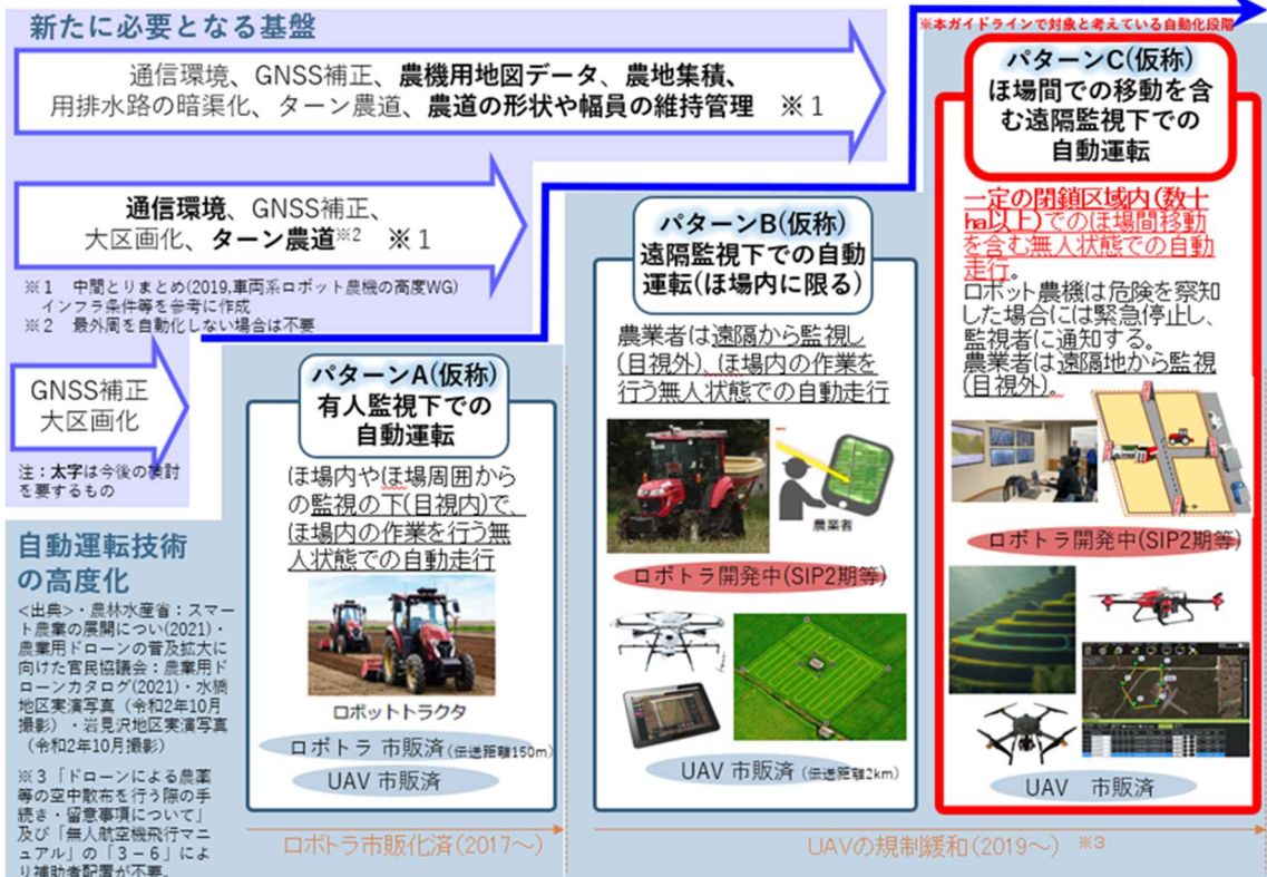
図 1-1 農機の自動化の分類と新たに必要となる基盤
