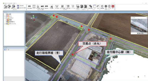
図1 高精度3次元メッシュデータと図化情報
