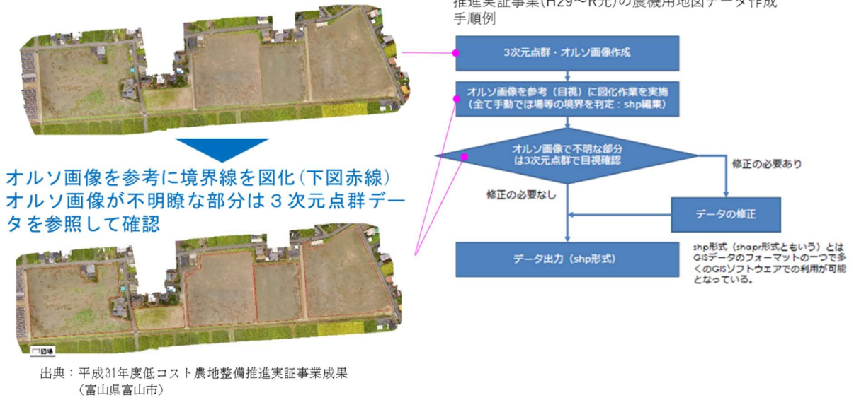
図 1-5 オルソ画像を基にほ場外周線を作成した事例 (富山県富山市)
