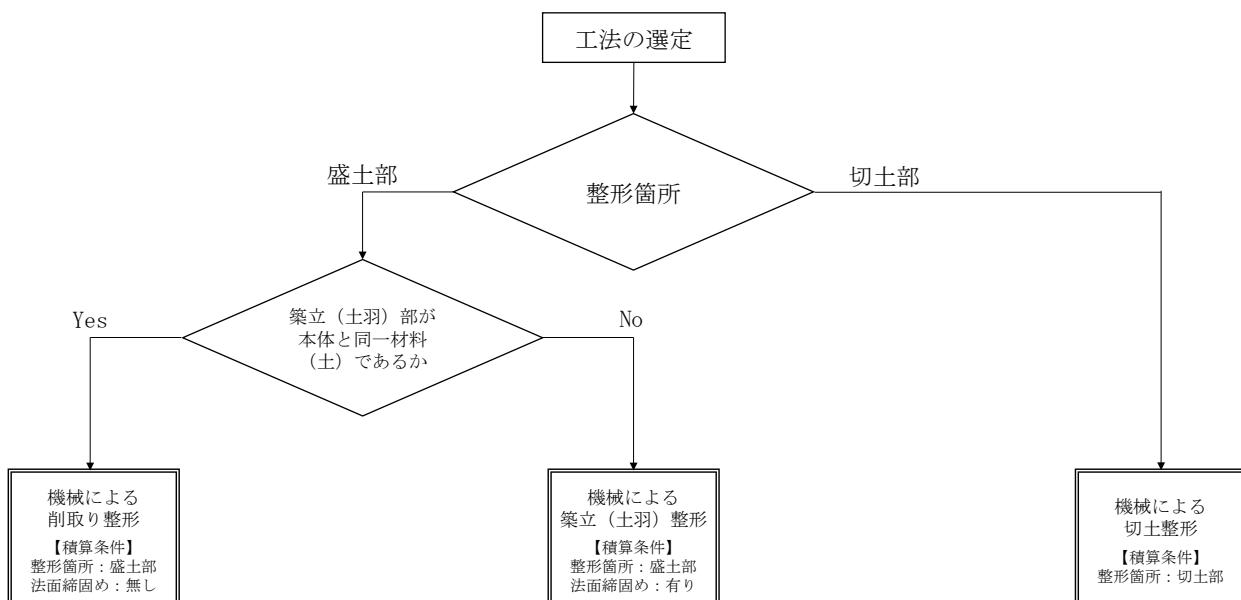
※ 盛土部の施工フローは、「積算基準 施工パッケージ基準1. 土工④法面整形工」の図3. 2を、切土部の施工フローは図3. 3を参照のこと。
