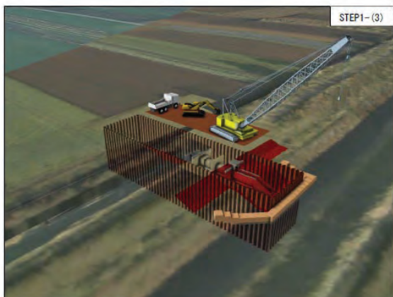
図 3-36 施工計画において活用する BIM/CIM モデルの例（1）
