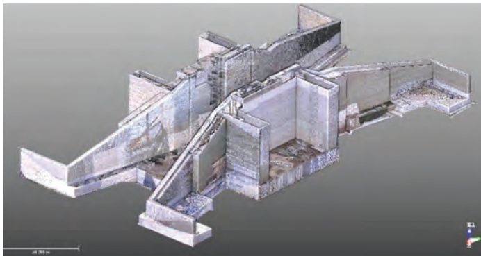
3次元測量から得られた点群データモデル
