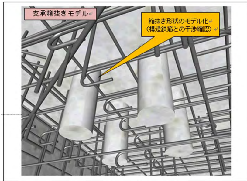
図 3-25 モデルイメージ（支承箱抜き：下部工）
