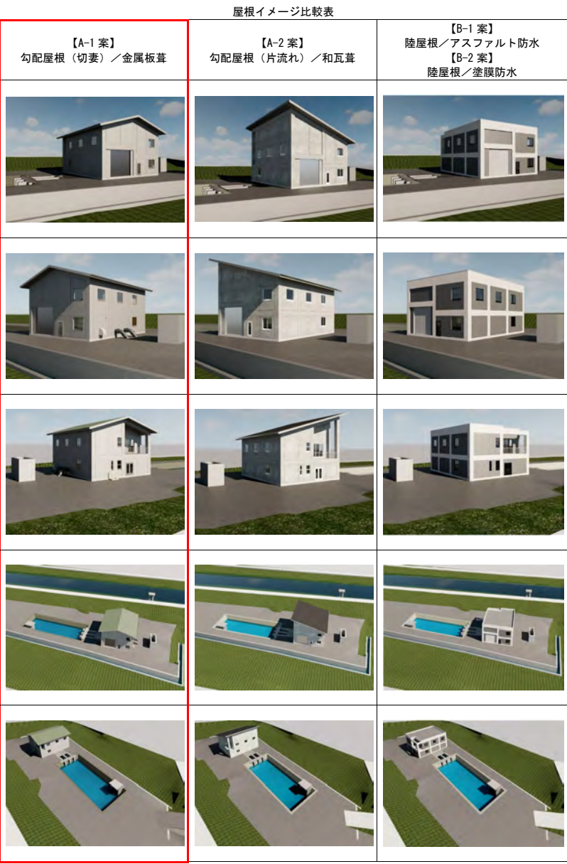
図 3-31 景観設計において活用する BIM/CIM モデルの例（1）
