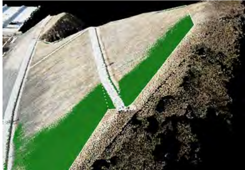
3次元測量から得られた点群データモデル 出来形管理ヒートマップ
