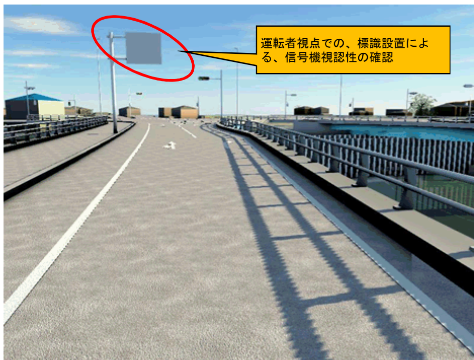
図 3-22 モデルイメージ（外部干渉照査）
