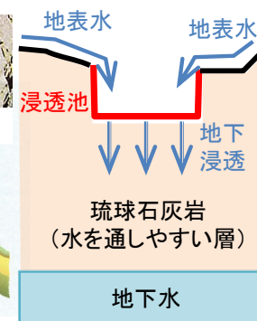
浸透池の排水のしくみ
