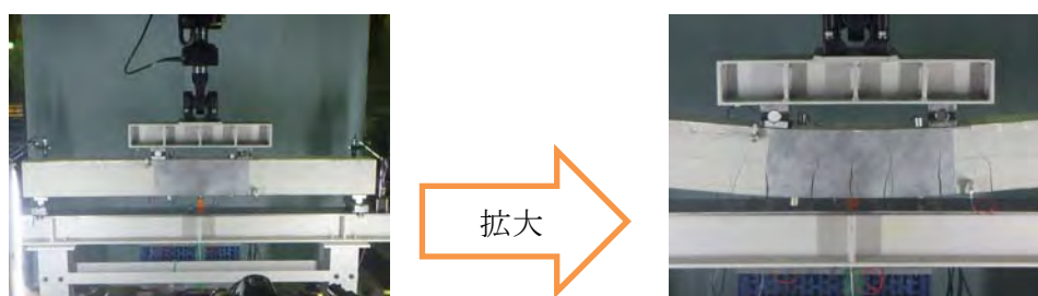
図 1-6-4-3 梁曲げ載荷試験実施状況
