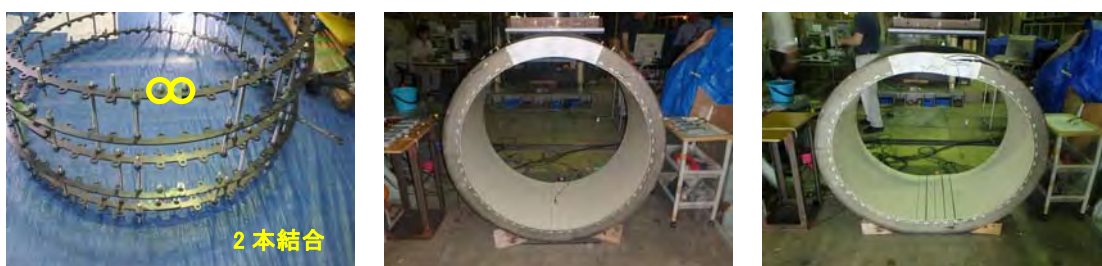
図 1-6-4-2 平成 28 年度円環外圧強度試験実施状況
