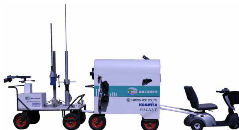
図-3.2 水路連続非破壊調査システム (CCDラインカメラ+内空断面計測+地山簡易貫入試験)
