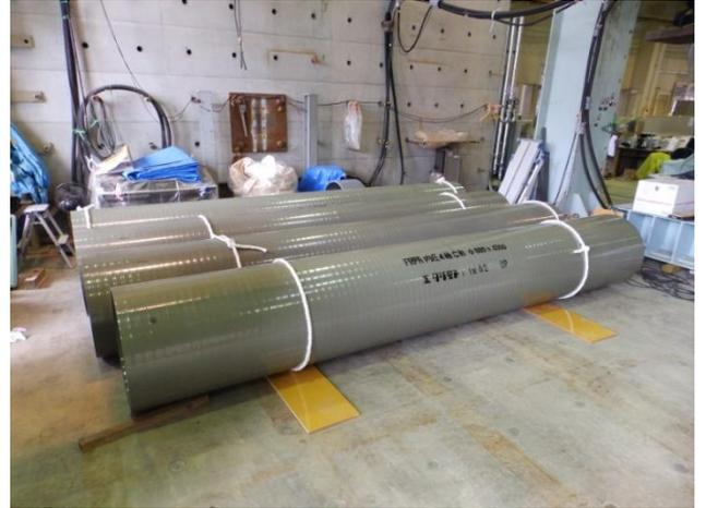
図 1.3.2 FRPM 管 (JIS A 5350)
