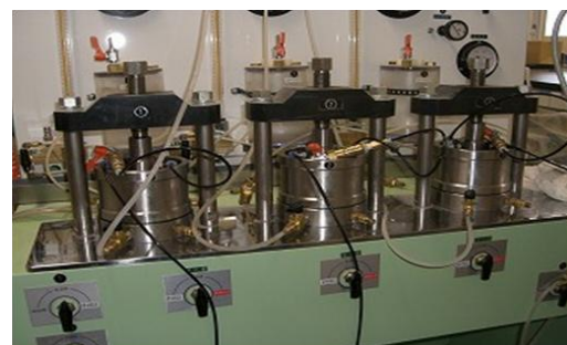
写真-5 透水試験状況 (左：微細ひび割れ発生後のHPCRCCの例、右：試験の実施状況)
