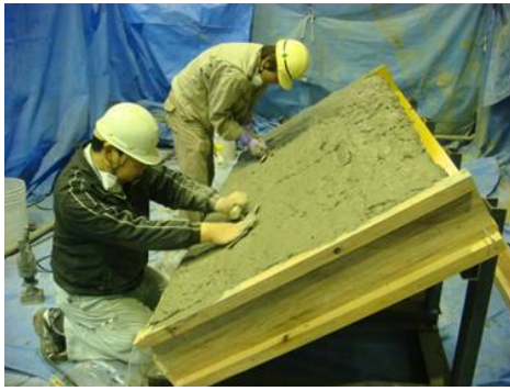
写真-2 ため池堤体への施工性確認試験
