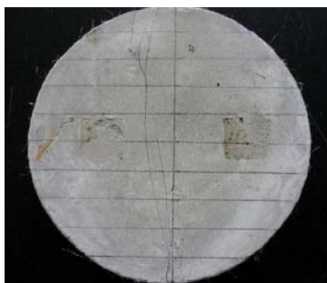
写真-5 透水試験状況 (左：微細ひび割れ発生後のHPCRCCの例、右：試験の実施状況)
