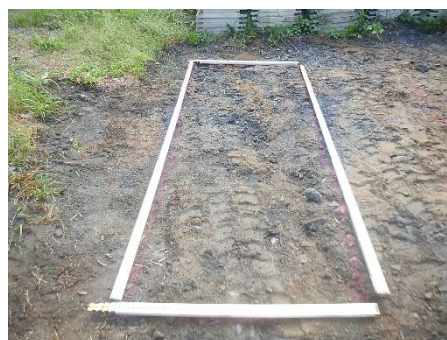
(n) 模擬農道平面寸法 ( B=1.0\text{m} , L=3.0\text{m} )
