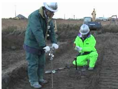
コーン貫入試験と供試体採取状況
