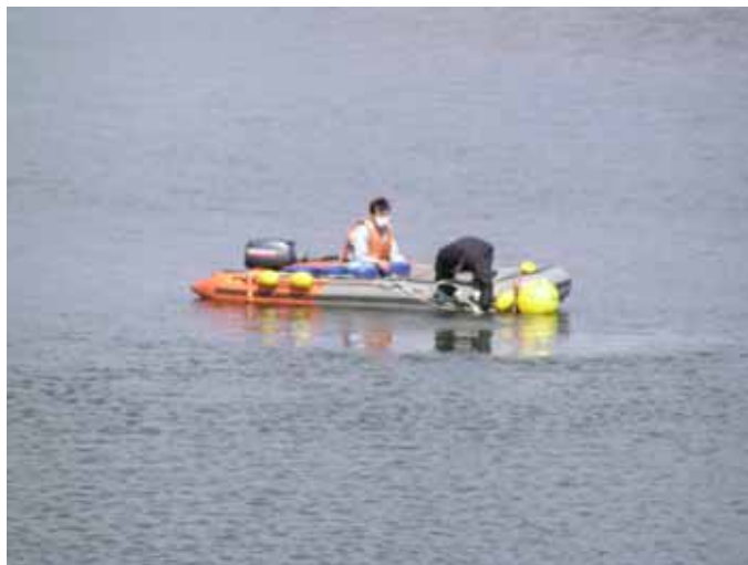
写真 - 1 貯水中の底泥土の採取 ( 潜水採取 )
