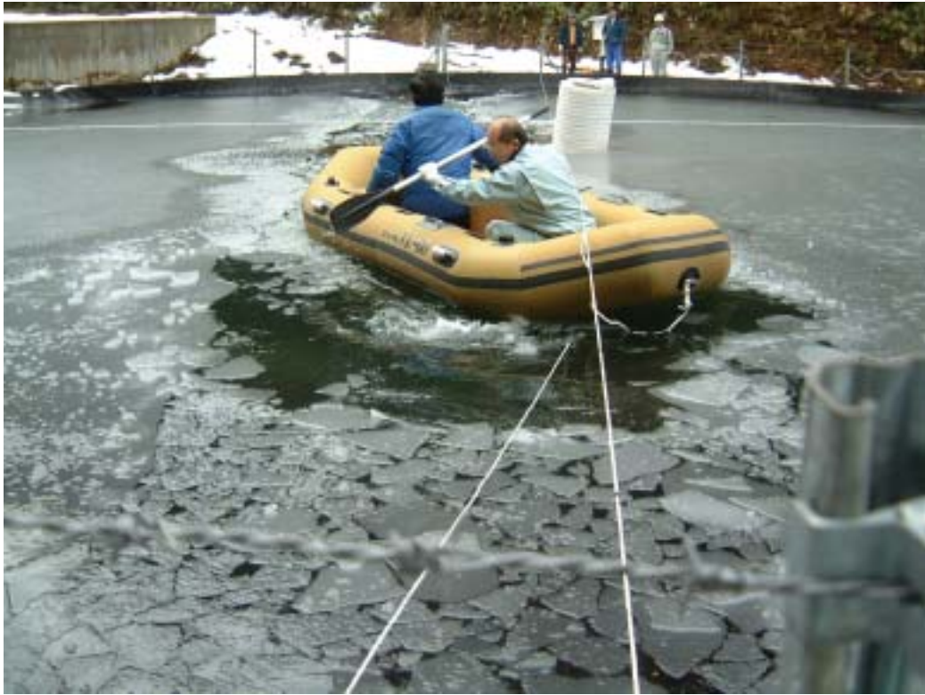
写真 - 8 凍結時のシート形状の測定状況.....特に温暖時と差違はなかった。
