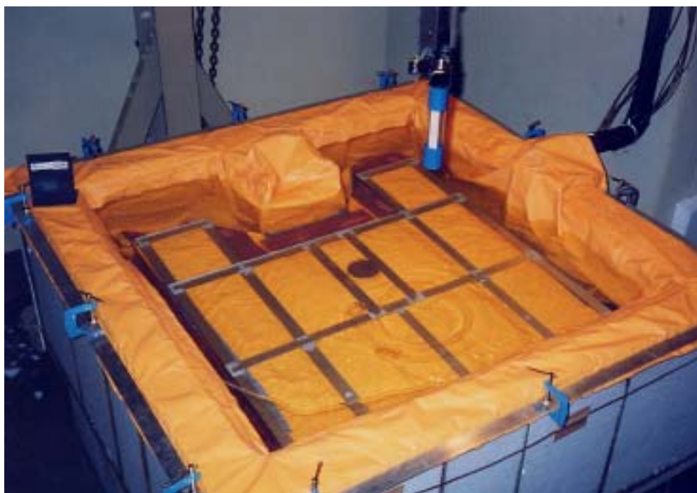
写真 - 7 マイナス 5 での凍結実験状況
