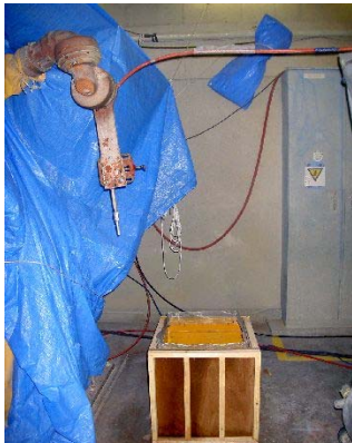
写真－6 WJによる摩耗試験概要
