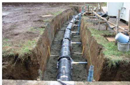
図 4.4 中口径模型実験管路
