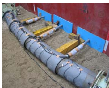
図 4.1 小口径模型実験管路
