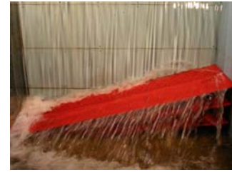
写真-4 傾斜板の流況
