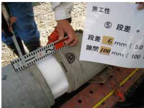
写真 6 5 段差 6mm + 隙間 100mm
