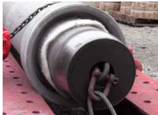
写真 6 20 ファイン管の抜け出し
