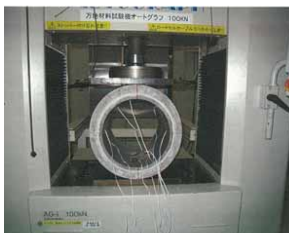
写真 4 - 1 緩衝性試験状況
