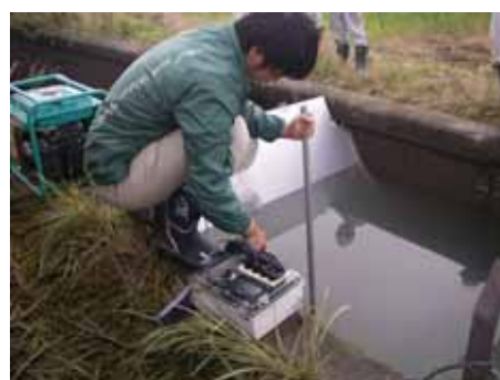
図-2.1.4 区間締切装置と併用した漏水検知状況
