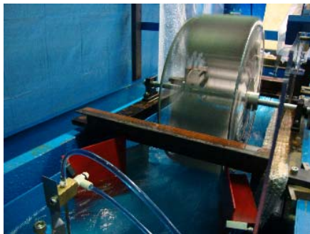
図-4:集水板設置状況
