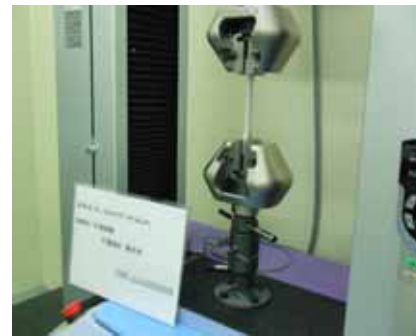
図 - 10 引張試験状況
