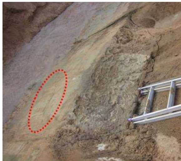
写真-5 ベントナイトペーストを塗布した覆土の落水後状況
