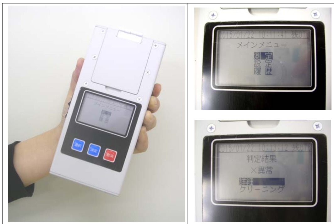
図 10 劣化簡易診断装置と指示画面
