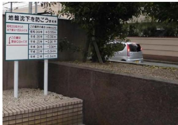
海水面レベル及び地盤沈下量の表示
