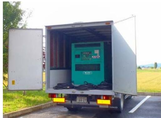
写真－3－6 発電機搭載車
