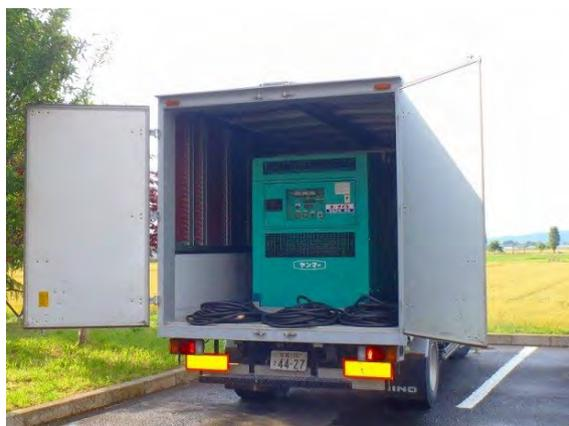
写真-4-4 発電機搭載車
