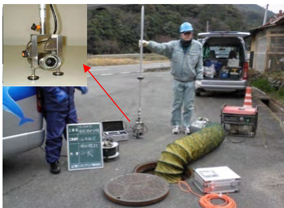
写真一5-2 二次調査（管口カメラ調査）器具と状況
