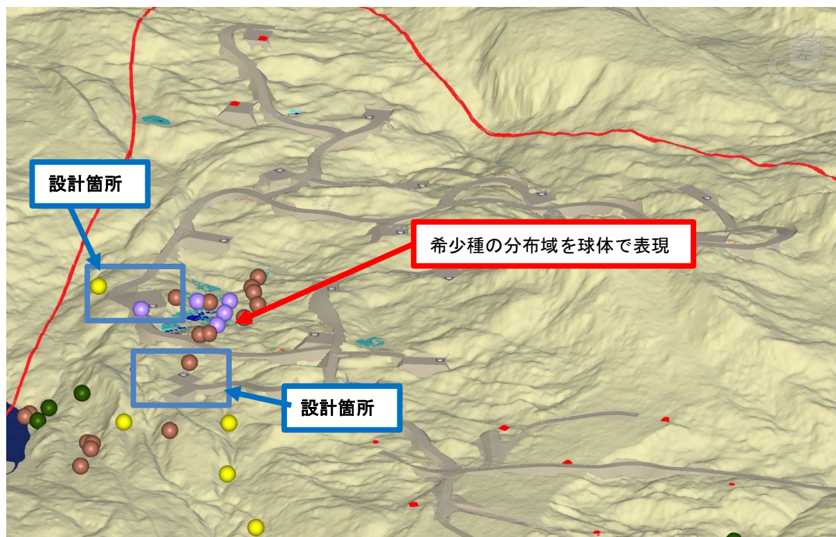
図3.30 BIM/CIMモデルを活用した希少種の分布域と施設配置箇所検討事例
