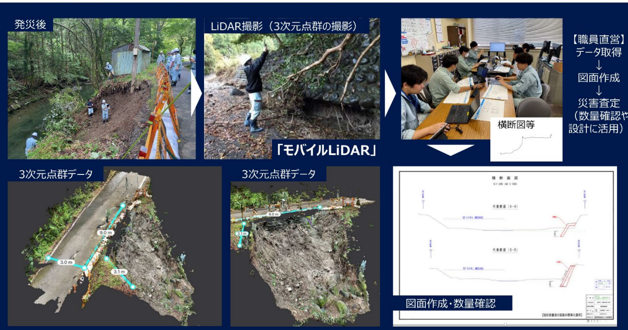
図 5.18 災害時の測量と査定図面の作成例
