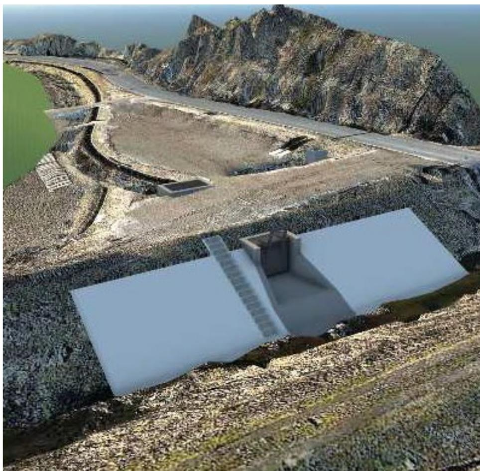
図 3-9 構造設計（一般図作成）において活用する BIM/CIM モデルの例
